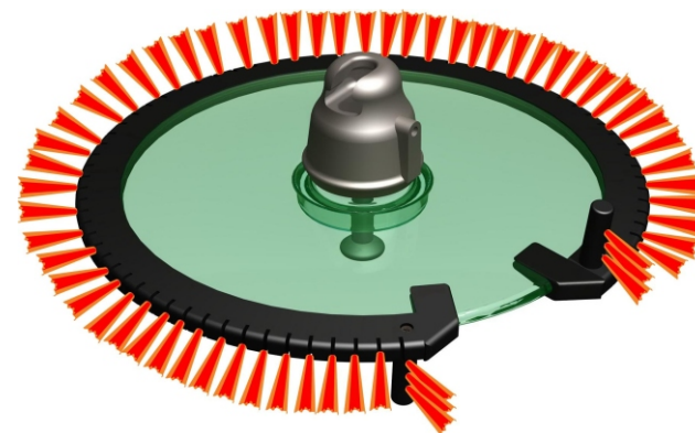
Рис.5 Эскиз и фотография изолятора-разрядника при срабатывании МКС
