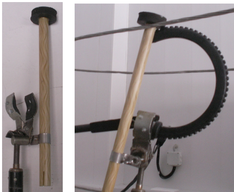
Рис.10 Изоляционная штанга для подъема разрядника на опору и выставления воздушного промежутка при монтаже под напряжением.
